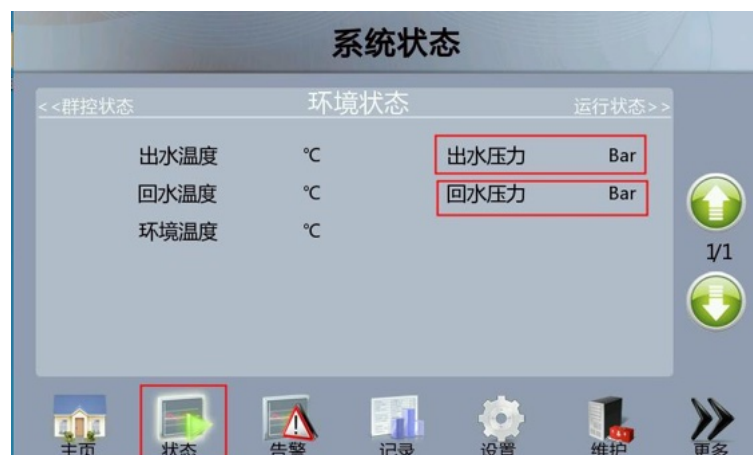
Abbildung 5-5-11: Druckeinstellung am Kühlaggregat
