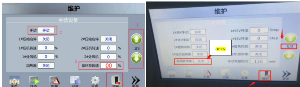
Abbildung 5-5-15: Einstellungen für das Nachfüllen am Kühlaggregat
