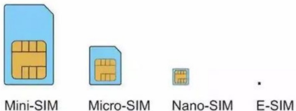
Abbildung 2-15-8: Abmessungen der SIM-Karte
