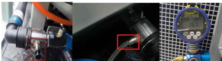
Abbildung 5-5-8: Druckprobe am Flüssigkeitskühlsystem
