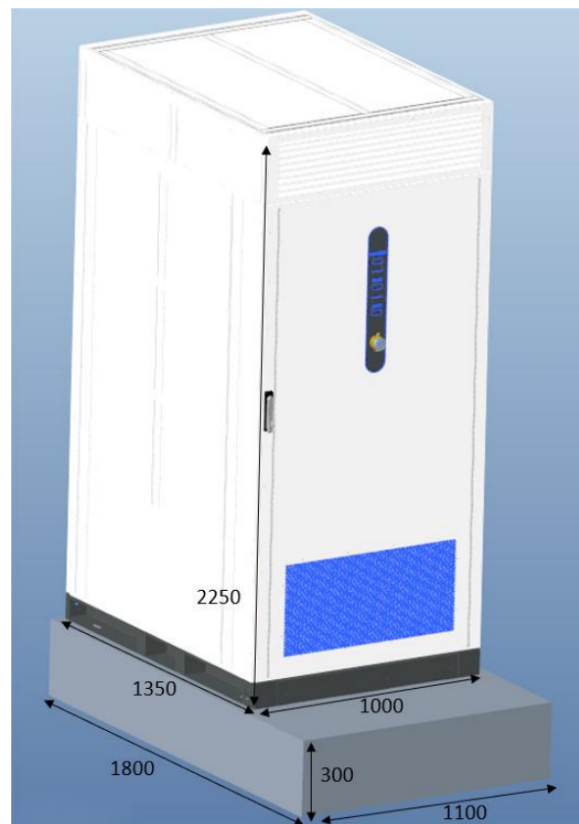
Abbildung 4.1-4 3D-Darstellung der Einzelschrank-Installation (Einheit: mm)
